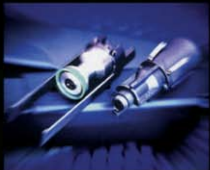
ติดตั้ง [Long Range System 7] ที่ถูกนำมาใช้ใหม่จาก M9 และท้ายลำกล้องผลิตจากแมกเนเซียม
